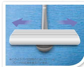
③ 仕上げに、ブレードの内面が床と平行になるようにします。ベイツストーンの背面(平面)を下方に向けて持ち、ブレードの内面と平行になるようにあてます。軽い力でストーンを左右に動かしながらバリを除去します。
